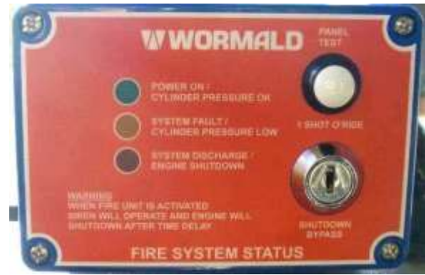
D11R FSS Monitoring Panel
